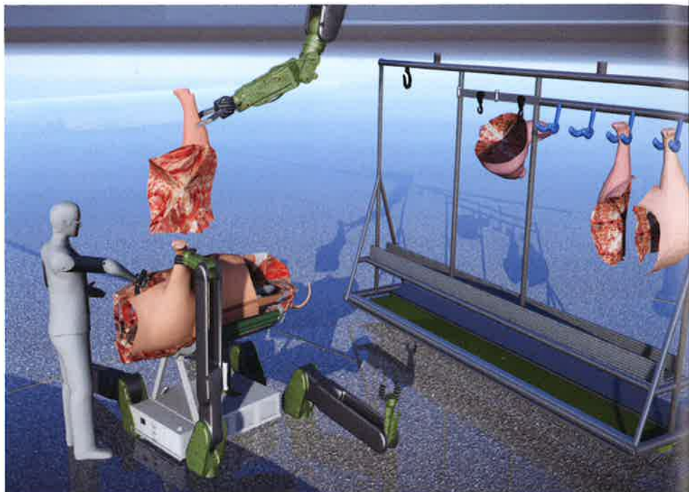
Skissen viser konseptet for produksjonsenhet for håndtering av skrotter, som illustrerer samarbeidet mellom menneskelige operatører og robotsystemer for manipulering, bæring og løfting av en skrottpåse. ILLUSTRASJON: HÅKON SVERDVIK
